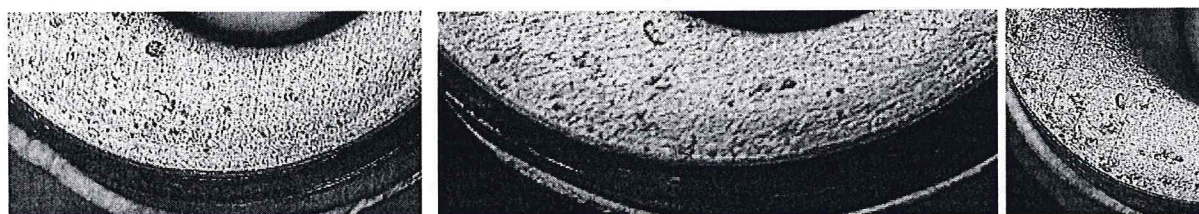
Рисунок 1. Повреждения на деталях из сплава НММц 38-2В в местах попадания строительной пыли после УЗО, 16 х .
