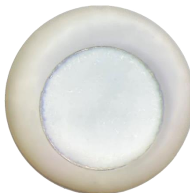
Рис. 2. Катод с нанесенным карбонатным покрытием
