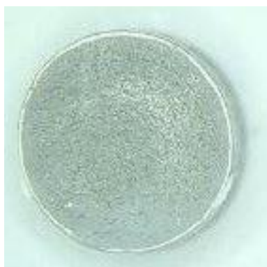
Рис. 1. Катод, синтерированный никелевым порошком
