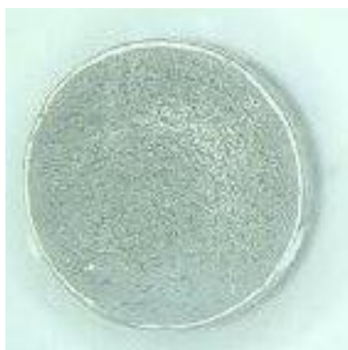
Рис. 1. Катод, синтерированный никелевым порошком
