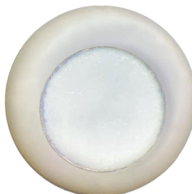
Рис. 2. Катод с нанесенным карбонатным покрытием
