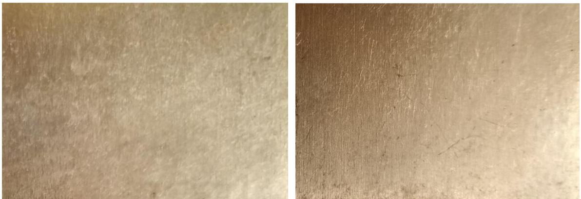
Рис. 3. Вид покрытия Хим.Н.тв.Н6 на поверхности детали после галтовки,  $4\times$ .
