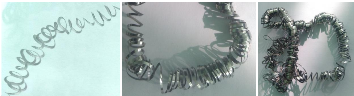
Рис. 2. Общий вид стружки при точении образцов 2 (слева) и 5 (в центре и справа).
