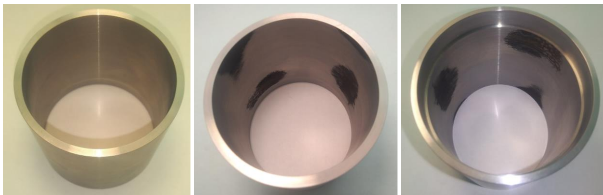
Рис. 1. Вид заготовки детали «Экран» и невыработок на её внутренней поверхности.
