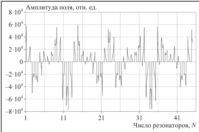
Рис. 4. Графическое представление распределения электрического поля вдоль АЗС магнетрона с \lambda = 1,28 мм Fig. 4. Electric field distribution along the filling station of the magnetron with \lambda = 1.28 mm
