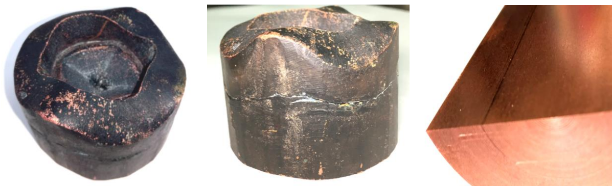
Рис. 1. Формирование центральной утяжины (слева) и кольцевых складок (в центре) в поковке, и полоса в зоне расслоения прессованного прутка из меди М0б (справа)
