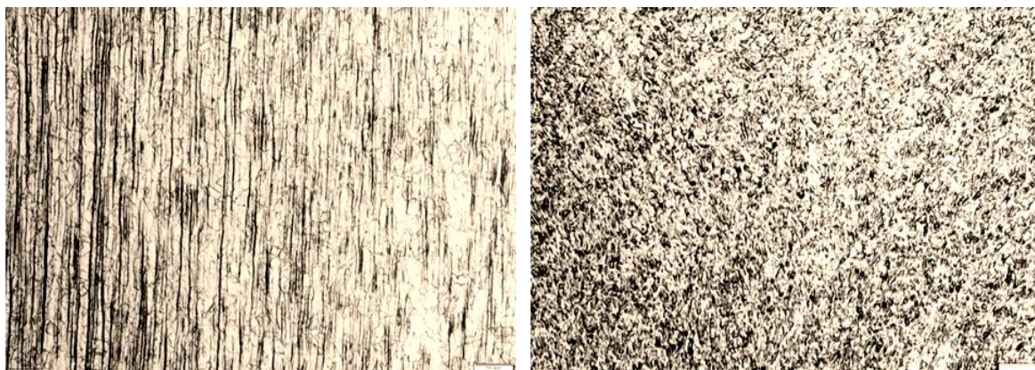
Рис. 1. Продольный (слева) и поперечный (справа) шлифы качественной структуры тянутого материала прутка после травления, 100\times
