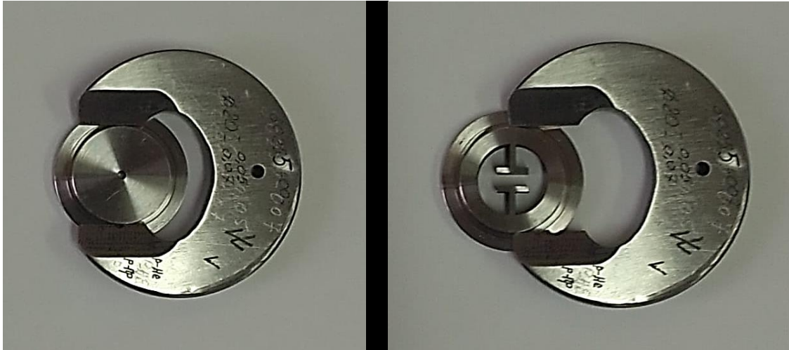
Рис. 1. Изменение контролируемого размера \varnothing 20^{-0,05}_{-0,07} после вырезки паза.
