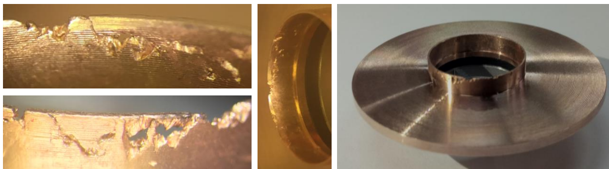
Рис. 1. Разрушение по границам зёрен детали типа «Тарелка» в процессе точения Fig. 1. Destruction along the grain boundaries of the "Plate" type part in the process of turning
