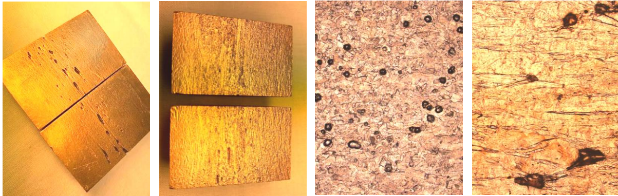
Рис. 2. Вызванные неправильной дегазацией поры в прутке (справа увеличено 50 × ) Fig. 2. Caused by improper degassing of the pores in the bar (on the right, enlarged 50 × )
