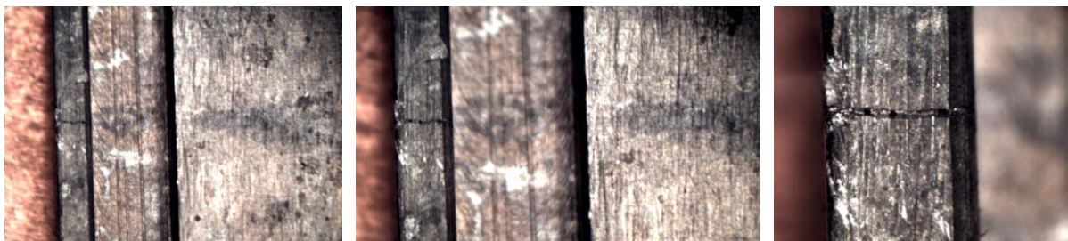
Рисунок 3. Разрушение крышки микросборки после нанесения на заготовку из сплава АМг5 покрытия ХН 6...9. Увеличение 10, 16, 40 ×
