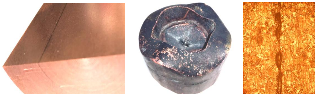
Рис. 1. КПО в прессованном прутке (слева, \times 2 ), разрушение поковки (в центре) и типичная макротрещина в зоне КПО (справа, \times 50 )
