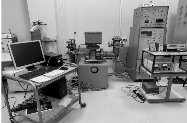
Рис. 2. Внешний вид установки для исследования автоэмиссионных свойств катодных материалов (УИАС-1).
