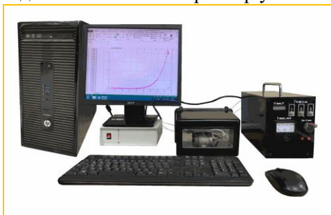
Рис. 4. Электрическая схема для измерения тока автоэлектронной эмиссии
